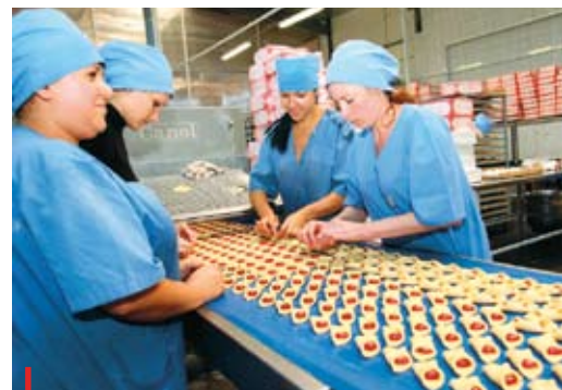
По необходимости на комбинате используется ручной труд. При ручной раскатке тесто не теряет воздух, тогда как машины его выдавливают, делая печенье тверже.
